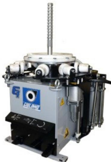
Автоматический шиномонтажный стенд для колес гоночных автомобилей с диаметром обода от 13" до 19" (максимальный диаметр колеса 640 мм/25", максимальная ширина колеса 330 мм/13"). Шиномонтажный стенд G1 Sport является результатом *технологических инноваций* компании Giuliano, и предназначен исключительно для самых известных международных автоспортивных соревнований.
